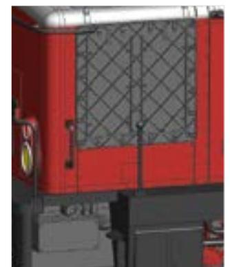
Dachlüfter- bzw. Kühlerabdeckung im offenen und geschlossenen Zustand montierbar
