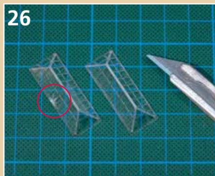
Oberlichtfenster sollten Sie vom Spritzling abtrennen, niemals abbrechen. Das Cuttermesser muss besonders scharf sein. Somit vermeiden Sie, dass das Kunststoffmaterial ausbricht.
