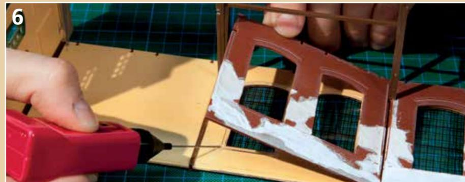
6 Vor dem Einbauen der Innenwände muss die Breite angepasst werden. Achten Sie beim Zusammenkleben der beiden Wände auf absolute Deckungsgleichheit. Bitte nur sehr wenig Kleber auf die Außenkanten der Fenster geben.
