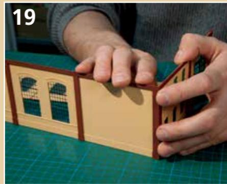
Das Zusammenfügen der Giebel- und Seitenwände muss absolut rechtwinklig erfolgen. Ansonsten passt das Dach nicht!
