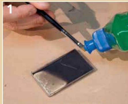
Je nach gewünschter Intensität mischen Sie Farbe, am besten von den Herstellern Humbrol oder Revell, mit mehr oder weniger Wasser und einigen Tropfen Spülmittel. Durch das Spülmittel verhindern Sie das Abperlen des Farbgemischs vom Kunststoff.
