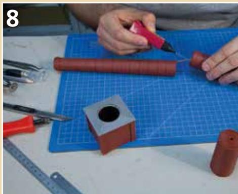
8 Jetzt können die Segmente mit sehr wenig Kleber zusammengefügt werden.
