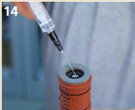
14 Zum Schluss wird der Generator mit Destillat befüllt.
