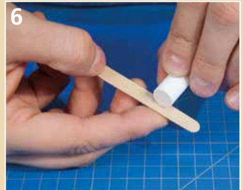
... mit einer Bastelfeile verschliffen. Um eine exakte Rundung zu erhalten, ist es sinnvoll das Werkstück auf der Feile zu drehen.
