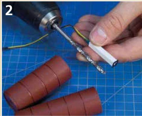
2 Wählen Sie den Bohrerdurchmesser so aus, dass das Kabel bequem durchgezogen werden kann, der Rauchgenerator aber nicht durchrutscht.
