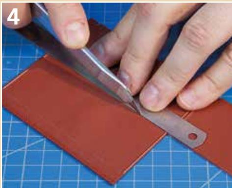
4 Das gekürzte Teil dient nun als Vorlage. Die Höhe wird auch auf zwei Wände des Art. 80 500 übertragen, die als Giebel genutzt werden. Dabei ist es wichtig, exakt zu arbeiten und ein scharfes Cuttermesser zu nutzen.
