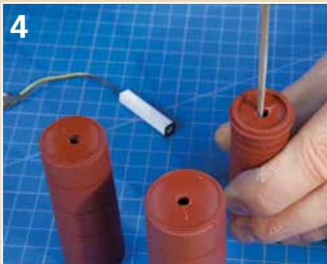
4 Zum Einbringen des Rauchgenerators wird das Loch im Schornsteinkopf eckig gefeilt.
