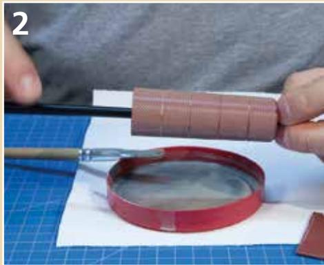
Um unschöne Farbläufer zu vermeiden, drehen Sie das Bauteil solange, bis die Farbe angetrocknet ist.
