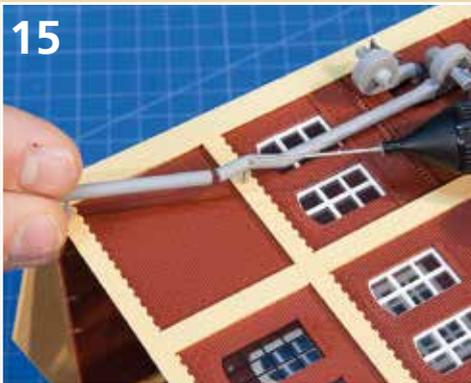
15 Die Absauganlage einschließlich der Verlängerung lassen sich besser befestigen, wenn das Gebäude „liegt“. Bitte verwenden Sie bei der Montage von Anbauteilen immer nur sehr sparsam Kleber.
